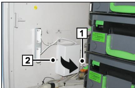
Удалите винты (1) и (2) из кожуха. Стяните кожух в направлении стрелки со стенки сейфа и снимите его.
